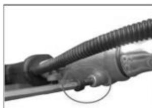
2. Conecte el cable del acelerador y el cable de encendido/apagado.
